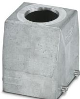
Custodia protettiva B32, per bloccaggio trasversale, materiale: Pressofuso di alluminio, impermeabile, uscite cavi: 1, diritto, 1x M50, altezza: 94 mm, connessione a vite per cavo: senza, Standard
