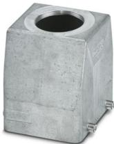
Custodia protettiva B32, per bloccaggio trasversale, materiale: Pressofuso di alluminio, impermeabile, uscite cavi: 1, diritto, 1x M40, altezza: 94 mm, connessione a vite per cavo: senza, Standard
