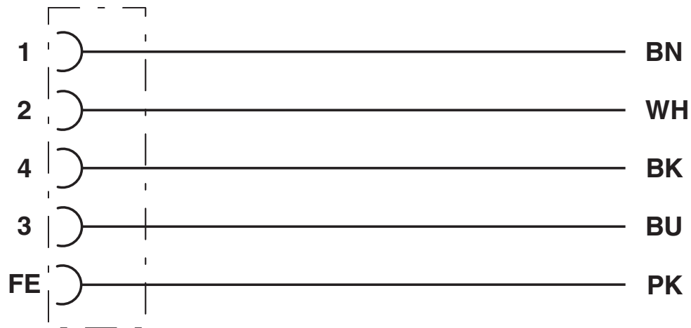
Equipaggiamento dei contatti del connettore femmina M12
