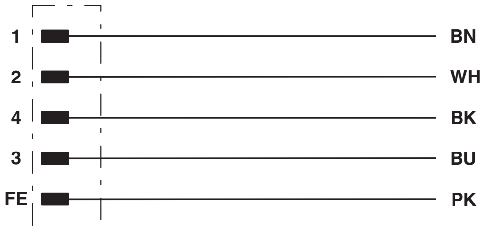
Equipaggiamento dei contatti del connettore M12
