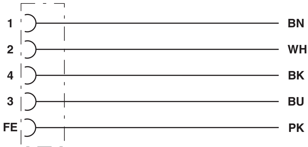
Equipaggiamento dei contatti del connettore femmina M12
