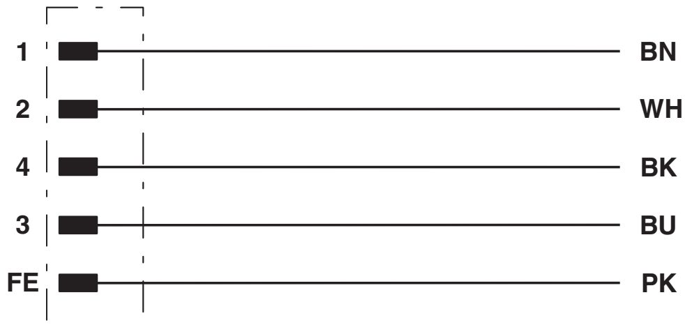
Equipaggiamento dei contatti del connettore M12
