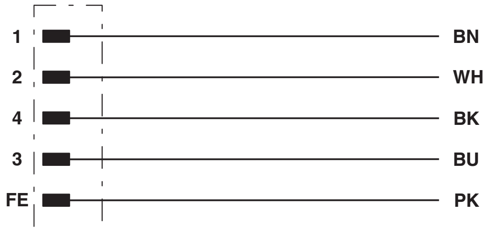
Equipaggiamento dei contatti del connettore M12
