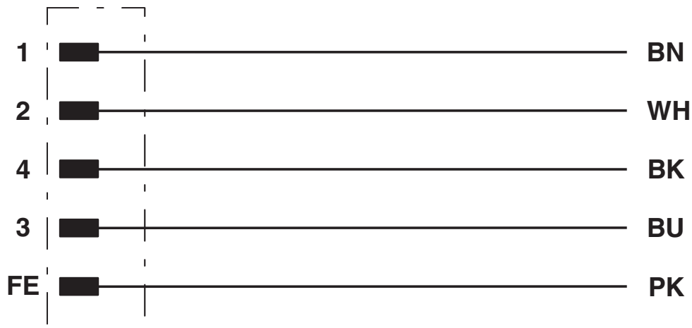
Equipaggiamento dei contatti del connettore M12
