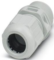
Pressacavi, materiale connessione a vite: PA, applicazione: Standard, diametro esterno cavo 9 mm ... 17 mm, schermatura: no, filettatura: M25 x 1,5, colore: grigio luce RAL 7035
