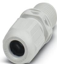
Pressacavi, materiale connessione a vite: PA, applicazione: Standard, diametro esterno cavo 3 mm ... 7 mm, schermatura: no, filettatura: M12 x 1,5, colore: grigio luce RAL 7035
