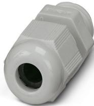
Pressacavi, materiale connessione a vite: PA, applicazione: Standard, diametro esterno cavo 4 mm ... 8 mm, schermatura: no, filettatura: M16 x 1,5, colore: grigio luce RAL 7035
