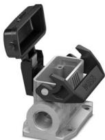
Custodia a zoccolo D15, con blocc. longitudinale, materiale: Pressofuso di alluminio, impermeabile, materiale coperchio: PC, uscite cavi: 2, laterali, 2x M20, altezza: 52 mm, connessione a vite per cavo: senza, coperchio di protezione: sì, Standard
