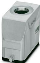
Custodia protettiva D15, per bloccaggio longitudinale, materiale: Pressofuso di alluminio, impermeabile, uscite cavi: 1, diritto, 1x M20, altezza: 56 mm, connessione a vite per cavo: senza, Standard
