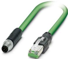
Cavo di rete, PROFINET CAT5 (100 MBit/s), EtherCAT® CAT5 (100 MBit/s), 4-poli, PUR senza alogenati, verde RAL 6018, schermata (Advanced Shielding Technology), Maschio diritto M8, codifica: D / IP67, su Maschio diritto RJ45 / IP20, lunghezza cavo: 10 m
