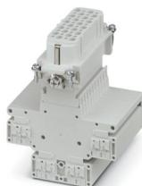
Adattatore per morsetti, numero poli: 40+PE, numero di connessioni per polo: 2, Femmina, Connessione Push-in, 250 V, 10 A, 0,5 mm<sup>2</sup> ... 1,5 mm<sup>2</sup>
