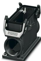
Custodia a zoccolo B24, con blocc. trasversale, materiale: PA 6.6-FR, uscite cavi: 2, laterali, 2x M32, altezza: 84 mm, connessione a vite per cavo: senza, Standard, inclusi 2 adattatori di riduzione
