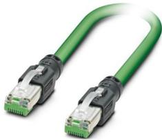
Cavo patch, grado di protezione: IP20, lunghezza cavo: 4 m, numero poli: 4, 100 MBit/s, CAT5, materiale: PA 6.6, PROFINET
