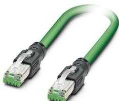
Cavo patch, grado di protezione: IP20, lunghezza cavo: 15 m, numero poli: 4, 100 MBit/s, CAT5, materiale: PA 6.6, PROFINET
