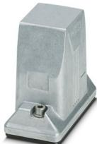
Custodia protettiva B10, con bloccaggio a vite, materiale: Pressofuso di alluminio, impermeabile, variabile, altezza: 93,7 mm, connessione a vite per cavo: senza, Offshore/EMC, senza apertura filettata per l'avvitamento, Guarnizione conduttiva (caratteristiche EMC)
