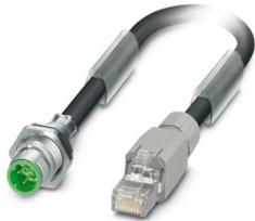
Cavo di rete, grado di protezione: IP20, lunghezza cavo: 1 m, numero poli: 4, CAT5, uscita cavo: diritto, PROFINET
