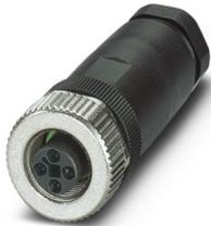
Connettore Power, 4-poli, non schermata, Femmina diritto M12, codifica: T, Connessione a vite, materiale zigrinato: Pressogetto di zinco, nichelato, connessione a vite per cavo Pg9, diametro esterno conduttore 6 mm ... 8 mm, per corrente continua fino a 12 A / 63 V
