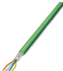
In metri, Cavo dati, PROFINET CAT5 (100 MBit/s), schermata, PVC, verde-giallo RAL 6018, 4-conduttori (1x4xAWG22/1, SF/TQ), colore conduttore singolo: bianco, giallo, blu, arancio, lunghezza cavo: 100 m
