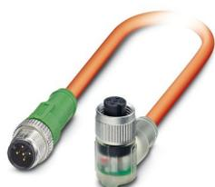
Cavo sensore/attuatore, 5-poli, PUR senza alogenati, resistente ai residui di saldatura, arancio RAL 2003, Maschio diritto M12, codifica: A, con 3 LED, su Connettore femmina diritto M12, codifica: A, con 3 LED, lunghezza cavo: 0,6 m, per robot e catene portacavi
