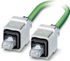
Cavo PROFINET confezionato, CAT5e, schermato, Sternvierer, AWG 22 flessibile (7 fili), RAL 6018 (giallo-verde), connettore maschio RJ45/IP67, Push-Pull, custodia in metallo, su connettore maschio RJ45/IP67, Push-Pull, custodia in metallo, Line, lunghezza: 5 m
