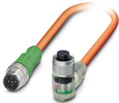
Cavo sensore/attuatore, 5-poli, PUR senza alogenati, resistente ai residui di saldatura, arancio RAL 2003, Maschio diritto M12, codifica: A, con 3 LED, su Connettore femmina angolato M12, codifica: A, con 3 LED, lunghezza cavo: 3 m, per robot e catene portacavi
