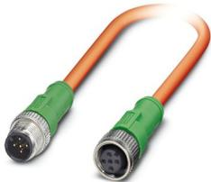
Cavo sensore/attuatore, 5-poli, PUR senza alogenati, resistente ai residui di saldatura, arancio RAL 2003, Maschio diritto M12, codifica: A, su Connettore femmina diritto M12, codifica: A, lunghezza cavo: 0,3 m, per robot e catene portacavi
