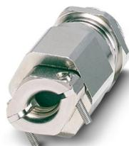
Pressacavi, materiale connessione a vite: Ottone, nichelato, applicazione: Standard, diametro esterno cavo 16 mm ... 28 mm, schermatura: no, filettatura: M40 x 1,5, colore: argento, con fermacavo, con O-ring
