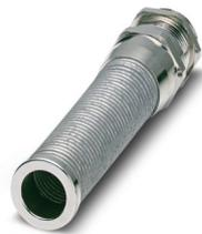
Pressacavi, materiale connessione a vite: Ottone, nichelato, applicazione: Standard, diametro esterno cavo 6 mm ... 13 mm, schermatura: no, filettatura: M20 x 1,5, colore: argento, con protezione anti piega, con O-ring
