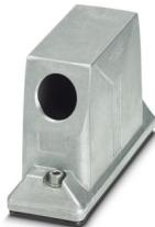
Custodia mobile HEAVYCON ADVANCE B24, con bloccaggio a vite (esagono cavo) in acciaio inox, alluminio impermeabile, altezza 93,7 mm, con filettatura 1x M25, uscita cavo laterale, senza superficie, guarnizione conduttiva (caratteristiche EMC)
