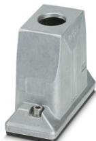
Custodia mobile HEAVYCON ADVANCE B16, con bloccaggio a vite (esagono cavo) in acciaio inox, alluminio impermeabile, altezza 93,7 mm, con filettatura 1x M25, uscita cavo diritta, senza superficie; guarnizione conduttiva (caratteristiche EMC)
