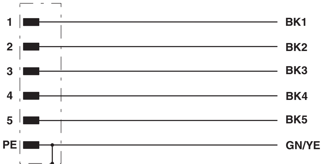
Equipaggiamento dei contatti del connettore M12
