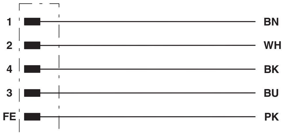
Equipaggiamento dei contatti del connettore M12
