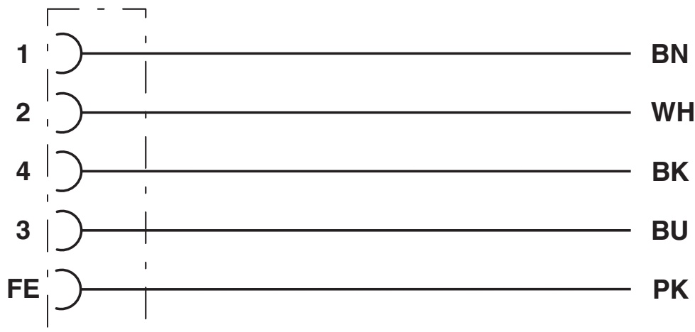
Equipaggiamento dei contatti del connettore femmina M12
