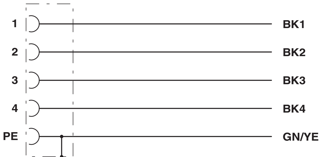
Schema di collegamento
