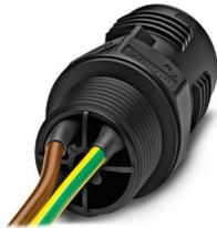
Passaparete, tipo di connessione: Fili singoli (saldato), numero poli: 2+PE, M20, 0,5 mm<sup>2</sup> ... 1,5 mm<sup>2</sup>, 690 V, 17,5 A, PA, nero, senza dado QUICKON, codifica: Profilo di codifica, 1,5 mm<sup>2</sup>, fili tagliati a livello, lunghezza cavo: 0,5 m
