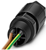
Passaparete, tipo di connessione: Fili singoli/ Connessione IDC, numero poli: 2+PE, M20, Spina, 0,5 mm<sup>2</sup> ... 1,5 mm<sup>2</sup>, 690 V, 17,5 A, PA, nero, con dado QUICKON, codifica: Profilo di codifica, diametro esterno conduttore: 10 mm ... 13 mm, 1,5 mm<sup>2</sup>, lunghezza cavo: 1 m
