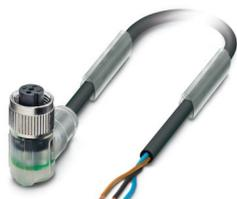
Cavo sensore/attuatore, 3-poli, PVC, nero RAL 9005, estremità conduttore libera, su Connettore femmina angolato M12, codifica: A, con 2 LED, lunghezza cavo: 3 m
