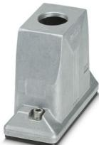
Custodia mobile HEAVYCON ADVANCE, B16, con bloccaggio a vite (esagono cavo) in acciaio inox, alluminio impermeabile, altezza 93,7 mm, con filettatura, uscita cavo diritta 1x M32, senza superficie, guarnizione conduttiva (caratteristiche EMC)
