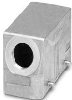
Custodia protettiva B16, per bloccaggio trasversale, materiale: Pressofuso di alluminio, impermeabile, uscite cavi: 1, laterali, 1x Pg16, altezza: 60 mm, connessione a vite per cavo: senza, Standard
