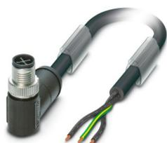
Cavo di alimentazione, 3-poli, PVC, nero, Maschio angolato M12, codifica: S, su estremità conduttore libera, lunghezza cavo: 1 m, per corrente alternata fino a 16 A/690 V
