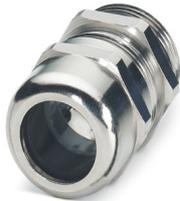
Pressacavi, materiale connessione a vite: Ottone, nichelato, applicazione: EMC, diametro esterno cavo 22 mm ... 32 mm, schermatura: sì, filettatura: Pg36, colore: argento, con O-ring
