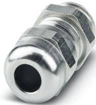
Pressacavi, materiale connessione a vite: Ottone, nichelato, applicazione: Standard, diametro esterno cavo 3 mm ... 6,5 mm, schermatura: no, filettatura: M12 x 1,5, colore: argento, con O-ring
