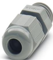
Pressacavi, materiale connessione a vite: PA, applicazione: Standard, diametro esterno cavo 5 mm ... 10 mm, schermatura: no, filettatura: M16 x 1,5, colore: grigio-argento RAL 7001
