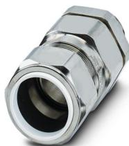
Pressacavi, materiale connessione a vite: Ottone, nichelato, applicazione: Ex, diametro esterno cavo 23,7 mm ... 33,9 mm, schermatura: sì, filettatura: M32 x 1,5, colore: argento
