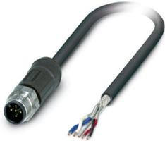
Cavo di sistema bus, CANopen®, DeviceNet™, 5-poli, FRNC senza alogenati, nero, schermata, Maschio diritto M12, codifica: A, su estremità conduttore libera, lunghezza cavo: 2 m, per applicazioni outdoor, con zigrinatura in acciaio inox
