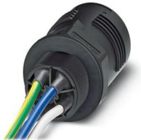
Passaparete QUICKON, 4+PE poli, 2,5 mm<sup>2</sup> ... 6,0 mm<sup>2</sup>/690 V/40 A, senza dado QUICKON, nero, filettatura M25 con 5 fili di conduttore saldati da 6,0 mm<sup>2</sup>, lunghezza 1,0 m, tagliati a livello all'estremità.
