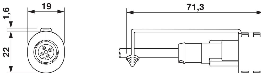
Connettore maschio montato con EXCLIP
