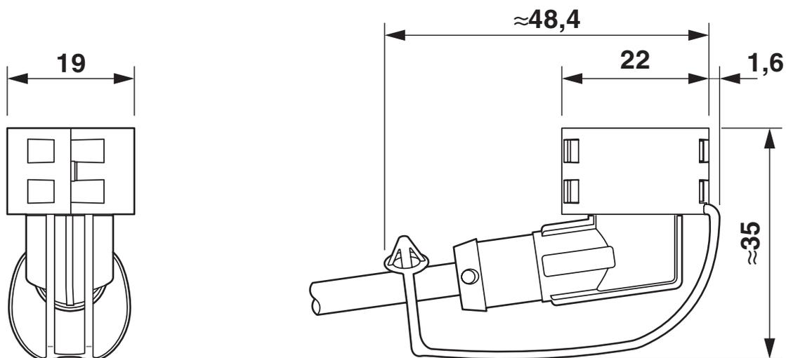
Connettore maschio montato con EXCLIP
