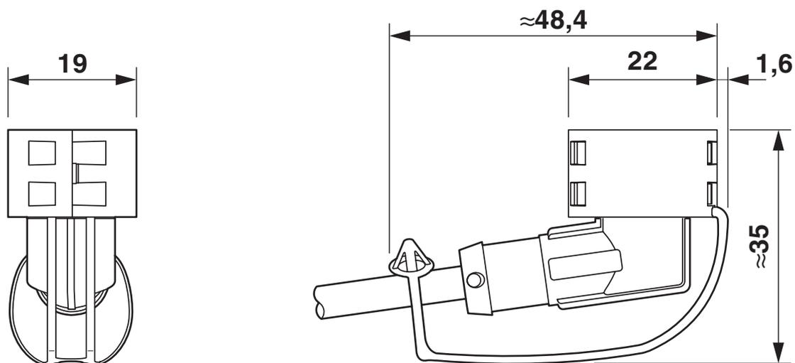
Connettore maschio montato con EXCLIP
