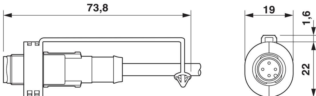
Connettore maschio montato con EXCLIP
