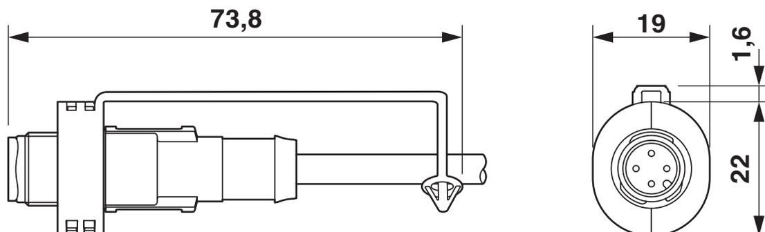
Connettore maschio montato con EXCLIP
